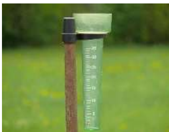
Regenmesser, einfachste Ausführung
